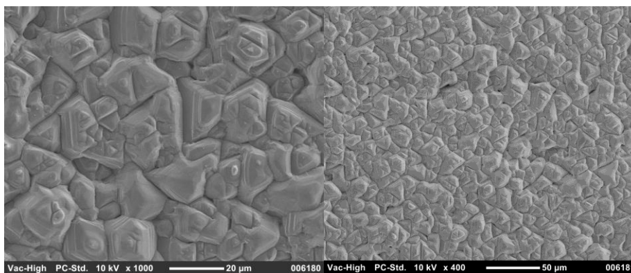
Рисунок 2.12. Морфологія поверхні плівки \text{CdTe} /слюда.
