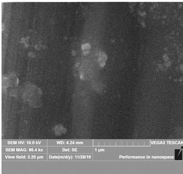
Рис. 3.29. CdS 5а. Температура підкладки T_{\text{П}} = 200^{\circ}\text{C} , температура випарника T_{\text{В}} = 880^{\circ}\text{C} , час осадження \tau = 150 с, товщина плівки d = 1215 мкм.
