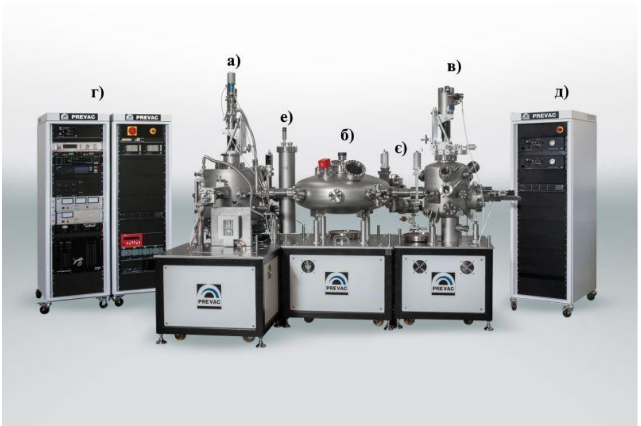
Рис. 2.4. Установка для вирощування тонких плівок методом лазерного імпульсного осадження: а) камера фізичного вакуумного осадження PVD, б) система транспортування зразків UFO, в) камера імпульсного лазерного осадження PLD, г) блок живлення, д) блок живлення камера PLD, е) камера зберігання MAG, є) система загрузки зразків.
