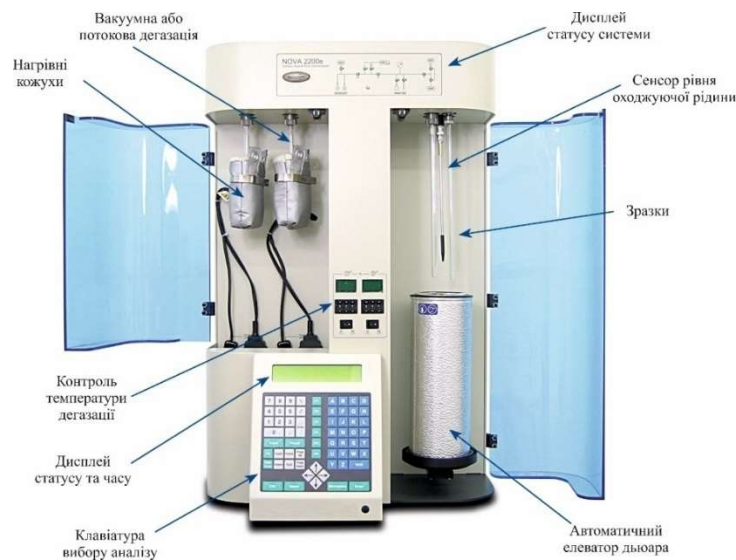
Рис. 2.3.1. Сорбтометр NOVA Quantachrome 2200e
