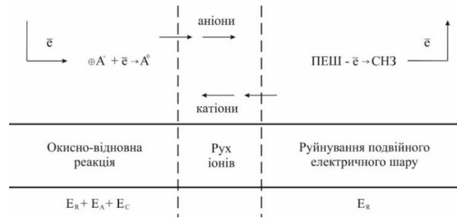
Рис. 1.3.1. Розрядний процес електрохімічної системи гібридного типу: A^+ , A^0 – активний матеріал у відновленій або окисленій формі; СНЗ – стан нульового заряду поляризованого електрода; E_R , E_A , E_C – активаційна і концентраційна поляризації
