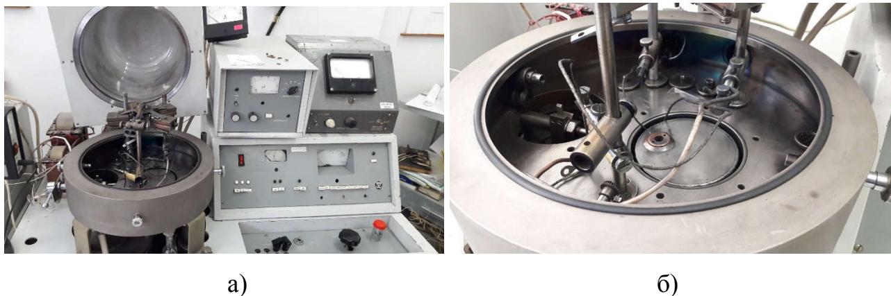
Рис. 2.3. Вакуумний універсальний пост ВУП-4: загальний вигляд (а) та вакуумна камера (б).
