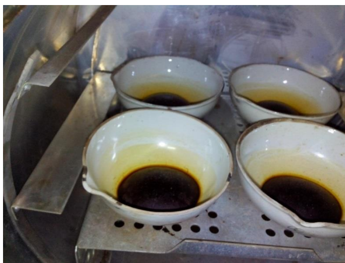
Рис. 2.1. Процес випаровування води з колоїдного розчину
