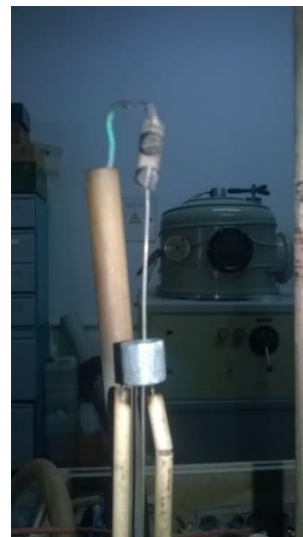
Рис. 2.9 Загальний вигляд приладу для вимірювання теплопровідності (а), вимірювальна комірка (б), і – кріплення зразка в приладі (в).
