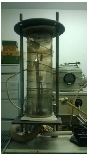
Рис. 2.9 Загальний вигляд приладу для вимірювання теплопровідності (а), вимірювальна комірка (б), і – кріплення зразка в приладі (в).
