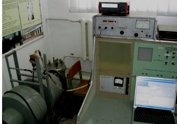
Рис. 2.5. Загальний вигляд установки автоматизованих вимірювань електричних параметрів напівпровідникових плівок.
